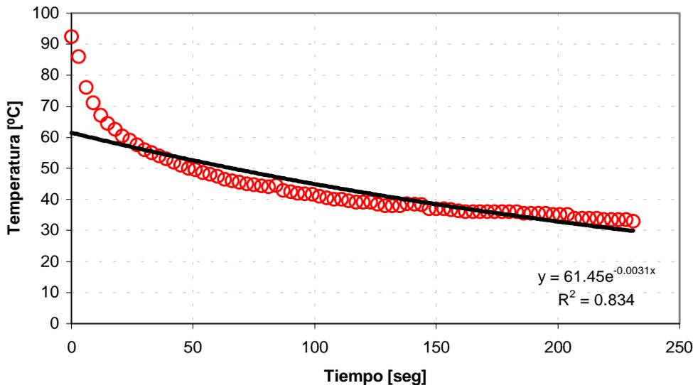
**Fig.1.** Representa el gráfico del enfriamiento de un termómetro en función del tiempo. Los símbolos rojos son los datos, la línea negra es la línea de tendencia que representa una relación exponencial entre el tiempo y el enfriamiento.  $R^2$  expresa la bondad del ajuste de los datos obtenidos a la ecuación  $y(x)$ .
