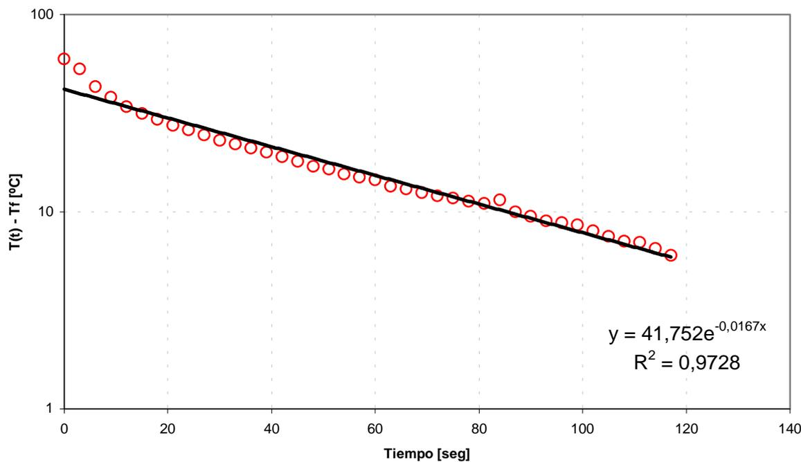
Fig. 3. Gráfico de dispersión con escala semilogarítmica (t(t)-tf). Los símbolos rojos son los datos, la línea negra es la línea de tendencia que representa una relación exponencial entre el tiempo y el enfriamiento del termómetro. R<sup>2</sup> expresa la bondad del ajuste de los datos obtenidos a la ecuación y (x). Se incluyen los datos obtenidos hasta la temperatura de 39 °C.
