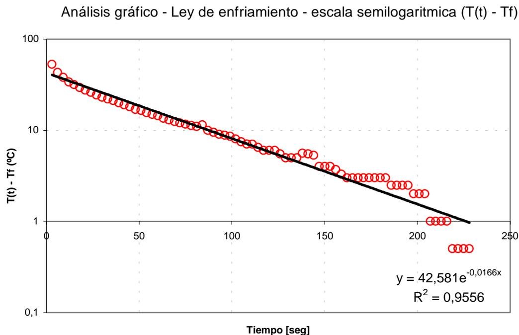
**Fig. 2.** Gráfico de dispersión con escala semilogarítmica ( $T(t) - T_f$ ). Los símbolos rojos son los datos, la línea negra es la línea de tendencia que representa una relación exponencial entre el tiempo y el enfriamiento del termómetro.  $R^2$  expresa la bondad del ajuste de los datos obtenidos a la ecuación  $y = f(x)$ .
